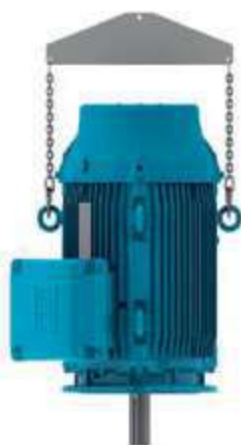
Рисунок 4.7 - Подъем электродвигателей вертикальной установки
