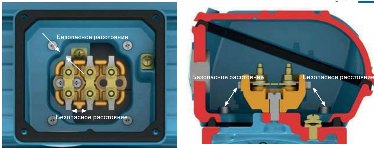
Рисунок 6.15 - Пример безопасного расстояния
