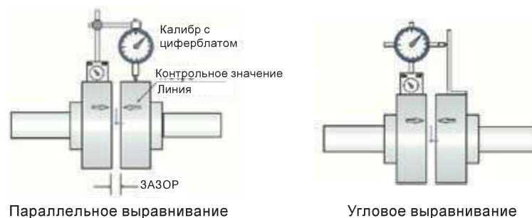
Рисунок 6.11 - Выравнивание с помощью калибра с циферблатом
