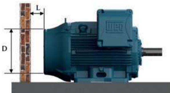
Рисунок 7.1- Минимальное расстояние до стены
