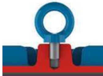
Рисунок 4.2 - Неправильное затягивание рым-болта
