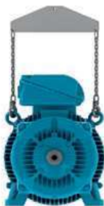
Рисунок 4.6 - Использование распорной траверсы при подъеме
