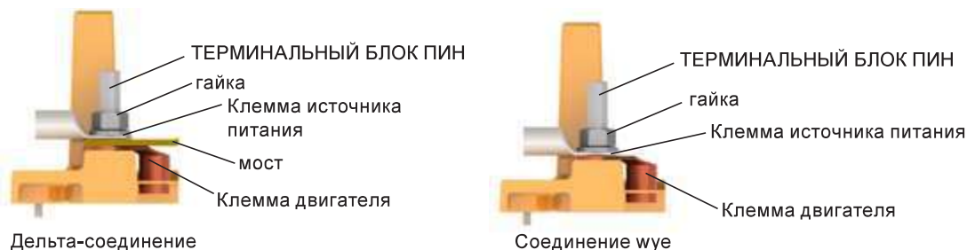
Рисунок 6.14 - Подключение для двигателей W50 и HGF с клеммной колодкой
