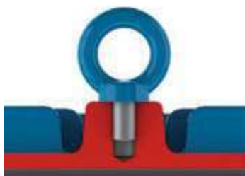
Рисунок 4.1 - Правильное затягивание рым-болта
