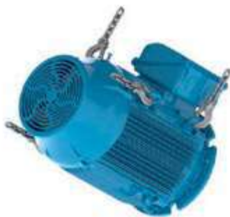
Рисунок 4.18 - Вращение двигателя в горизонтальное положение
