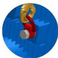
Рис. 4-3. Дополнительная информация по рым-болтам для перемещения электродвигателей с ребрами охлаждения (не поставляются с электродвигателем)
