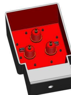
Рис. 8-14. Внутреннее устройство крышки РТВ
