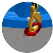
Рис. 4-3. Дополнительная информация по рым-болтам для перемещения электродвигателей с ребрами охлаждения (не поставляются с электродвигателем)
