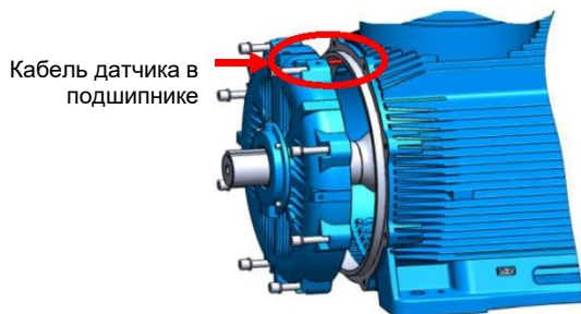
Рис. 8-8. Демонтаж подшипникового щита
