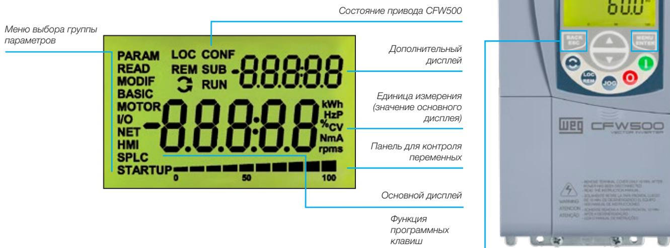
Примечание. Интерфейс управления (ЧМИ) привода CFW500 удалить невозможно. Для удаленного управления при помощи интерфейса ЧМИ используйте принадлежность CFW500-HMIR согласно таблице принадлежностей на стр. 19.
