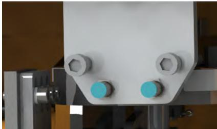
Рисунок 7.16: Датчики движения кулачка (SE4 и SE8)
