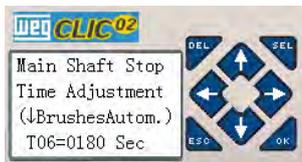
7. После подачи сигнала BR1 и отсчета времени T06, система опускает щетки и находится в ожидании в течение времени блокировки между пусками;
