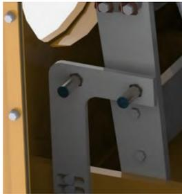
Рисунок 7.15: Датчики на рычаге привода втулки (SE3 и SE7)
